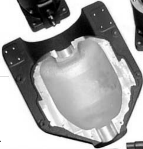
Wendegetriebe, Unterteil, rechts davon Oberteil
